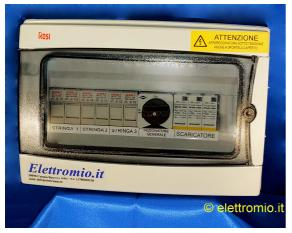
I Quadri DC sono indispensabili per garantire sicurezza all'impianto fotovoltaico. I quadri DC sono posti tra i moduli fotovoltaici e gli inverter e servono ad interrompere in caso di manutenzione il flusso di corrente continua verso l'inverter. Essi inoltre servono a proteggere l'impianto contro le sovracorrenti e sovratensioni.
