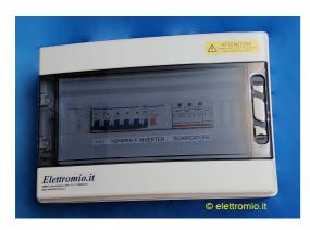
I Quadri AC sono indispensabili per garantire sicurezza all'impianto fotovoltaico sul lato alternata. I quadri AC servono ad interrompere in caso di manutenzione il flusso di corrente ed a proteggere la linea in partenza dall'inverter. Essi inoltre servono a proteggere l'impianto nel suo complesso contro le sovracorrenti e sovratensioni.
