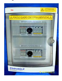
I Quadri DC sono indispensabili per garantire sicurezza all'impianto fotovoltaico. I quadri DC sono posti tra i moduli fotovoltaici e gli inverter e servono ad interrompere in caso di manutenzione il flusso di corrente continua verso l'inverter. Essi inoltre servono a proteggere l'impianto contro le sovracorrenti e sovratensioni.
