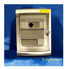
I Quadri DC sono indispensabili per garantire sicurezza all'impianto fotovoltaico. I quadri DC sono posti tra i moduli fotovoltaici e gli inverter e servono ad interrompere in caso di manutenzione il flusso di corrente continua verso l'inverter. Essi inoltre servono a proteggere l'impianto contro le sovracorrenti e sovratensioni.
