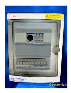
I Quadri DC sono indispensabili per garantire sicurezza all'impianto fotovoltaico. I quadri DC sono posti tra i moduli fotovoltaici e gli inverter e servono ad interrompere in caso di manutenzione il flusso di corrente continua verso l'inverter. Essi inoltre servono a proteggere l'impianto contro le sovracorrenti e sovratensioni.
